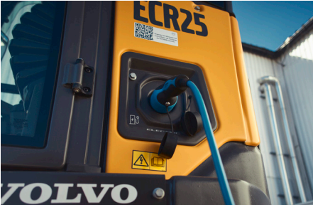
친환경 ELECTRIC 솔루션 기술 적용 배기가스 배출이 전혀 없는 ELECTRIC 배터리 충전 타입
